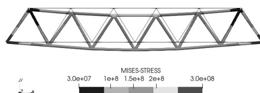
図 5 ミーゼス応力分布図 (変形×10)
